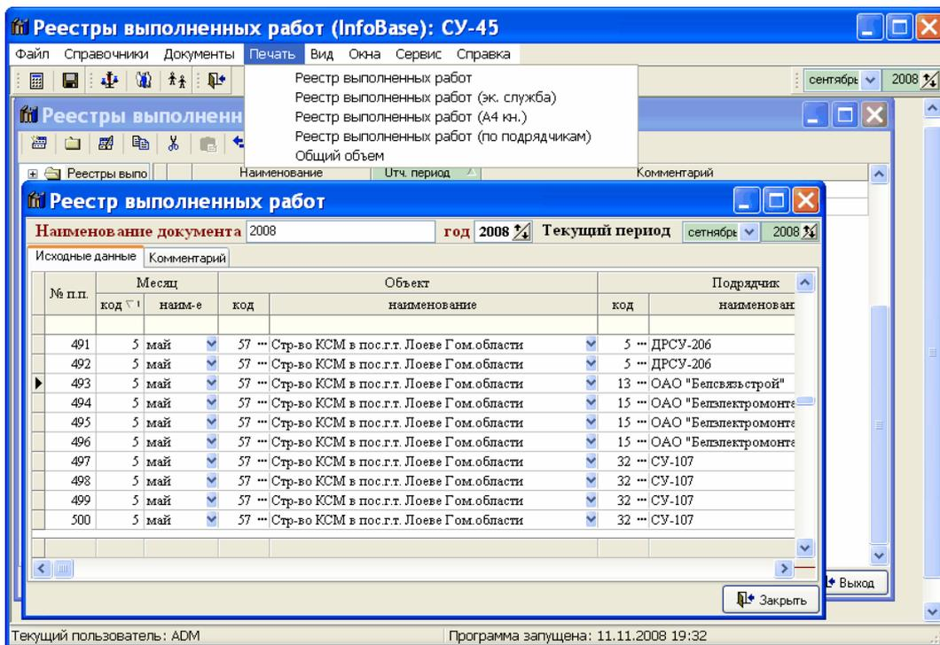
Программа **"Реестр выполненных работ"** отделов ПТО строительных организаций предназначена для учета выполнения строительно-монтажных работ в разрезах объектов, генподрядчиков, субподрядчиков, цен 1991 года, текущих цен и т.п.
